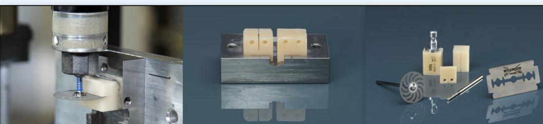
Entwicklung von CT-Proben für die Prüfung der Bruchzähigkeit von CAD/CAM-Keramik und Komposit-Blöcken
